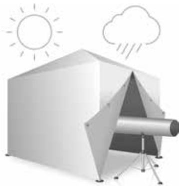
Abbildung C.1: Vorbereitung des Schweißplatzes nach DVS
